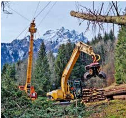
Der Prozessor am Bagger-Arm entastet ganze Baumstämme aufs Mal und zersägt sie.
